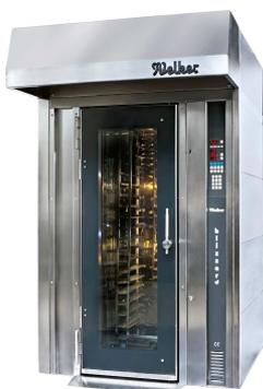
Der Stikkenofen BLIZZARD S2 wurde mit einer innovativen Türkonstruktion aus wärmedämmenden Spezial-Glasscheiben ausgestattet, die zur Vermeidung einer Wärmebrücke mit High-Tech-Silikonprofilen isoliert und beidseitig auf einen Edelstahl-Trägerahmen montiert sind.
